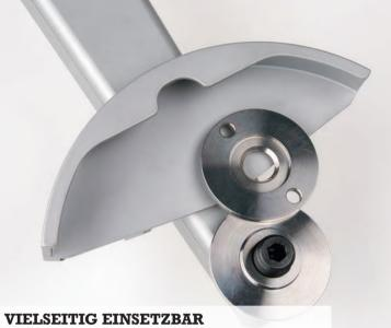
Die schlauen RVS-Flansche ermöglichen ein müheloses Montieren von Scheiben in unterschiedlichen Durchmessern und Dicken.
